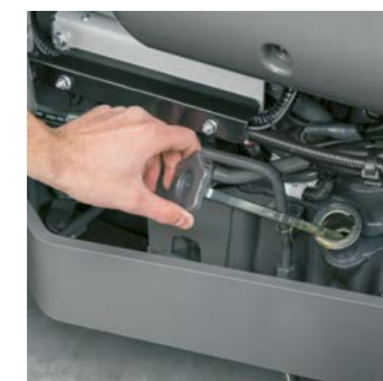
O controlo do nível de óleo e o reabastecimento é realizado com o capot fechado do lado direito do ELIOS 200.
