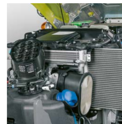
O filtro de ar PowerCore® está acessível na parte dianteira, sob o capot, e reduz os intervalos de limpeza.
