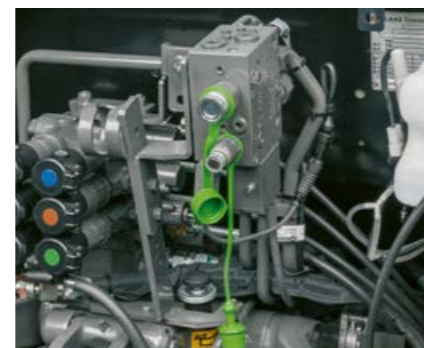
Com o travão do reboque de tubagem hidráulica dupla, continua flexível durante o transporte.
