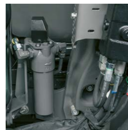
Os filtros do motor são facilmente acessíveis, mesmo com consolas de carregadores frontais.
