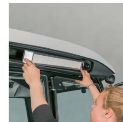
O filtro de ar da cabina é facilmente acessível do exterior para limpeza e facilita a refrigeração do ambiente na cabina.
