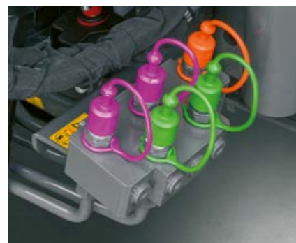
Na parte frontal direita da cabina encontram-se até quatro ligações hidráulicas, bem como um retorno livre.
