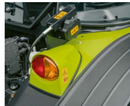
A regulação mecânica do elevador traseiro pode ser operada externamente na traseira para montagem do dispositivo.
