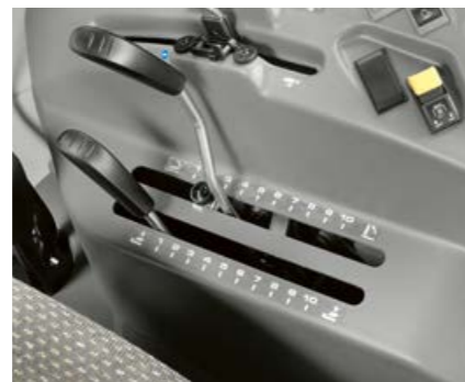
O controlo da regulação mecânica do elevador traseiro encontra-se localizado de forma ergonómica à direita, junto do lugar do condutor.
