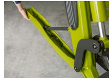
Picioarele de sprijin se pliază ușor sub braț și nu obstrucționează vederea asupra încărcătorului frontal.
