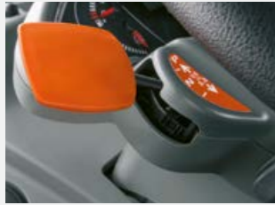
Pieejama REVERSHIFT bīdāma svira ar elektronisku bremsi.
