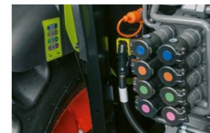
Tagumised ühendused on nende värvuskoodi ja lähedal asuva kleebise järgi kergesti tuvastatavad.
