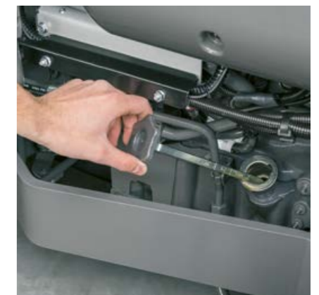
Õlitaset kontrollitakse ja õli lisatakse kinnise kapotiga ELIOS 300 paremalt küljelt.
