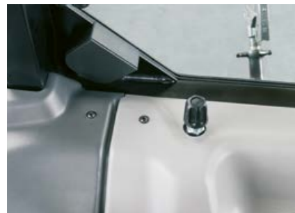
Mehaanilise hüdrojagaja nr 3 maksimaalset voolukiirust saab piirata kabiinist ühe käelligutusega.
