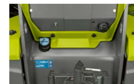
Gât de umplere cu AdBlue® ușor accesibil, pentru post-tratarea eficientă a gazelor de eșapament.
