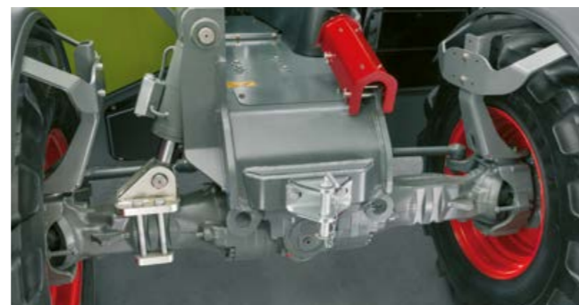
Mai multă siguranță off-road datorită reglării hidraulice a nivelului.
