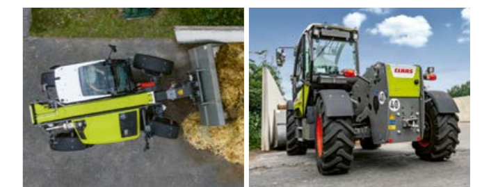
Mai multă acuratețe cu modul de deplasare în mod crab cu acționare manuală.
