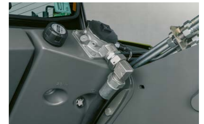
Nivelul uleiului hidraulic poate fi verificat convenabil printr-o fereastră de inspecție. Sistemul hidraulic este protejat de un filtru de retur care trebuie schimbat doar după 1.000 de ore de funcționare.
