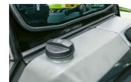
Rezervor de carburant ce poate fi înmuiat, amplasat în spatele cabinei.
