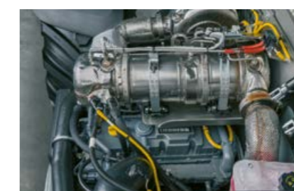
Filtrul de particule diesel este regenerat automat.
