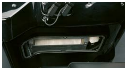
Acces bun la filtrul de aer proaspăt pentru cabină.
