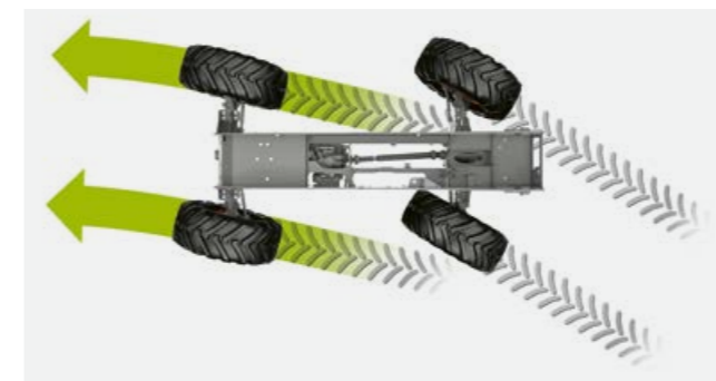
4 Deplasare în mod crab cu acționare manuală
