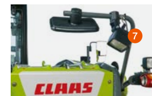
Halogenstrålkastare på backspegelfästet belyser området bakom maskinen
