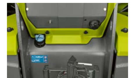
Påfyllning av AdBlue® för effektiv avgasrening, lätt åtkomlig påfyllningsstuds
