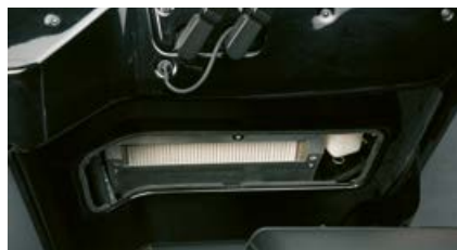
Hyttens luftfilter är lätt att komma åt
