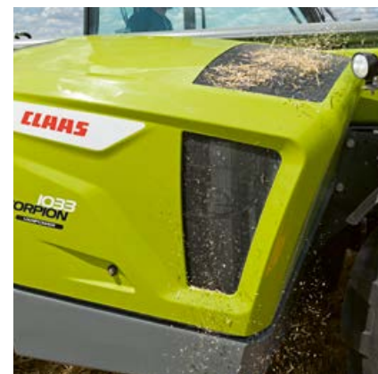
Reverserbar fläkt förebygger igensättning av kylaren
