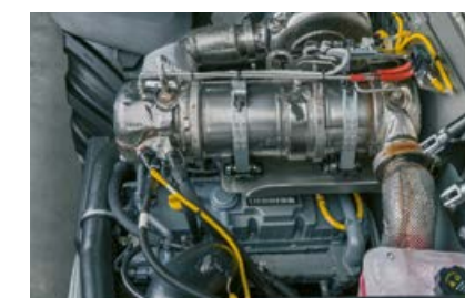
Dieselpartikelfiltret regenereras automatiskt.
