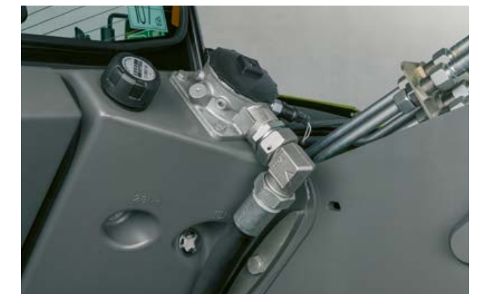
Hydrauloljenivån kan bekvämt kontrolleras via ett siktglas. Hydraulsystemet skyddas av ett returfilter. Filtret behöver bara bytas med 1000 drifttimmars intervall.
