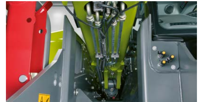
Sidostyrning för teleskoparmen integrerad i ramen är standard på alla lastare med lastkapacitet över 4500 kg
