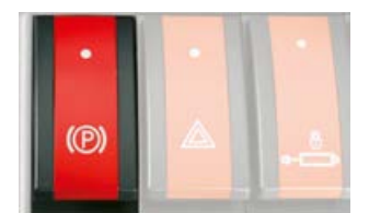
Parkeringsbromsen aktiveras manuellt via en vippkopplare.
