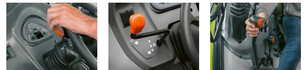
Den kopplingsfria fram/back-växlingen sitter greppvänligt till vänster bredvid ratten – elektronisk växling med REVERSHIFT eller mekanisk växling.
