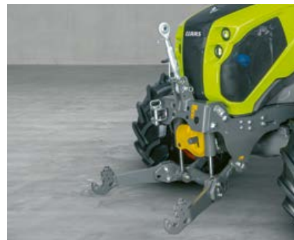
Frontlyften med 3,2 ton lyftkraft (tillval) samt det främre kraftuttaget breddar användningsområdet för ELIOS.
