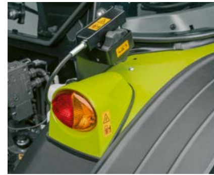
Den mekaniska bakre trepunktslyften kan manövreras utifrån, baktill på traktorn, för enklare redskapsmontering.
