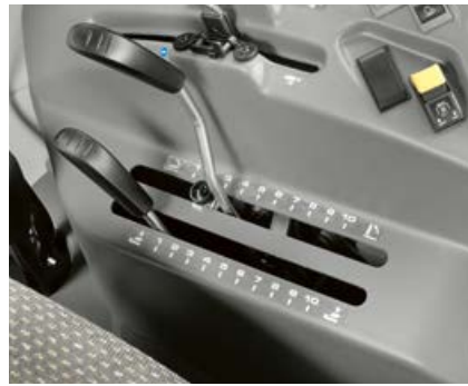
Manöveranordningar för den bakre trepunktslyften är ergonomiskt bekvämt placerade till höger om förarstolen.
