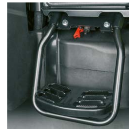
Batterifrånskiljaren är enkel att nå på det vänstra insteget (utom för ELIOS 210)
