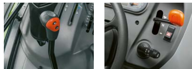
Du kan välja mellan en mekanisk växling till höger bredvid ratten eller en bekväm TWINSHIFT tvåstegs powershift som manövreras med växelspaken.
