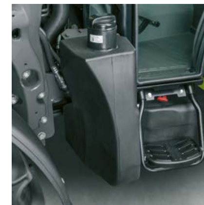
Dieseltanken 95 liter och ureatanken på 10 liter ger tillräcklig kapacitet även för långa och intensiva arbetsdagar.
