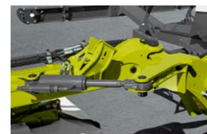
Ochrana díky hydraulické non-stop pojistce při najetí na překážku v případě kolize: Žací jednotka se vychýlí a zase se vrátí do výchozí polohy.
