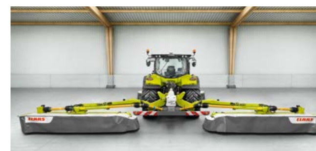
Dvě hydraulicky ovladatelná teleskopická ramena s plynulým nastavením pro optimální překrývání u modelu DISCO 1100 TREND.
