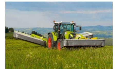
Díky kompaktnímu zavěšení v předních ramenech disponuje žací stroj na souvratí velkou světlou výškou.
