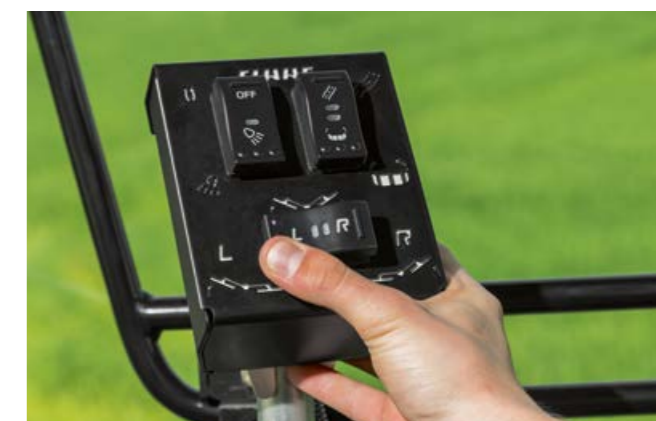
Pro model DISCO 1100 TREND je k dispozici praktická ovládací jednotka pro zdvih jednotlivých žací jednotek, sklopení v přepravní pozici a volitelně zapínání a vypínání pracovních světlometů.
