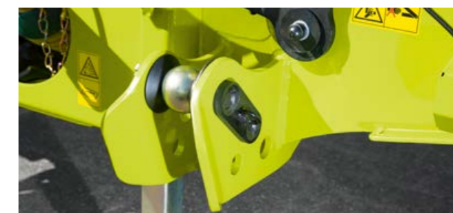
Vodící kulisy pro dolní táhla na pohodlné připojení.
