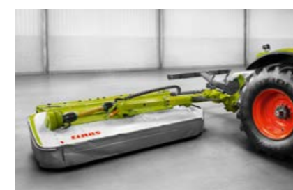
S hydraulicky ovládanými rameny je podle typu žacího stroje dosaženo pracovního záběru mezi 9,40 m a 10,70 m.
