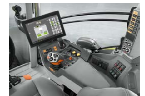
Jestliže je traktor vybaven terminálem ISOBUS, může být přednastavení pro CONTOUR ovládané přímo přes tento terminál.
