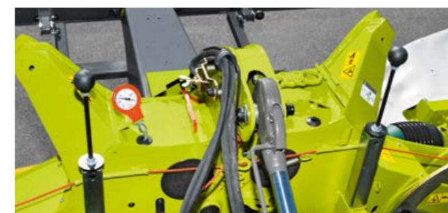
Manometr ke snadnému nastavení tlaku na povrch pole pro obě žací jednotky.
