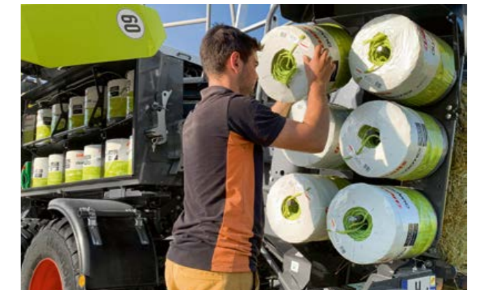
Pasirenkama: vieta 12 papildomų špagato ričių. Priklausomai nuo ryšulių dydžio, šio špagato pakanka 350–400 ryšuliu.
