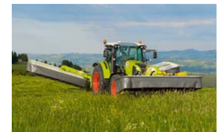
Niittolaitteen maavara on päisteessä suuri kompaktin etunostolaiteripustuksen ansiosta.
