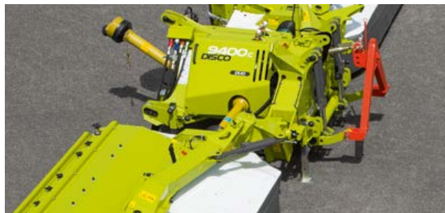
Non Stop hydraulinen laukaisulaite suojaa törmäyksiltä: Niittolaitte kääntyy taakse ja sen jälkeen automaattisesti käyttöasentoon.
