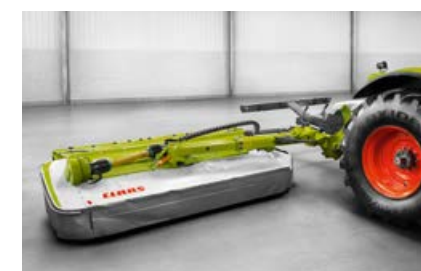
Hydraulisten teleskooppivarsiens ansiosta voidaan, etuniittolaitteesta riippuen, saavuttaa 9,40 m - 10,70 m työleveys.
