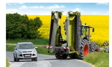
Alle 4 m: BUSINESS mallien kompakti kuljetusasento riittävällä maavaralla.
