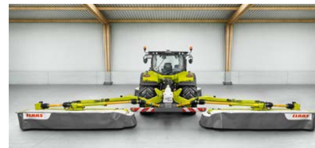
Kaksi hydraulisesti hallittavaa teleskooppista kannatinvarrta portaattomalla säädöllä optimoi niiton limityksen DISCO 1100 TREND mallissa.
