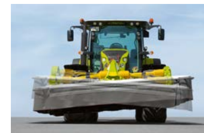
Vapaasti liikkuva heiluriripustus mahdollistaa pellon seurannan poikittaissuunnassa.
