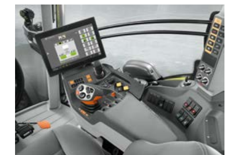
Jos traktorissa on ISOBUS yhteensopiva terminaali, voidaan CONTOUR esivalinta tehdä suoraan terminaalista.
