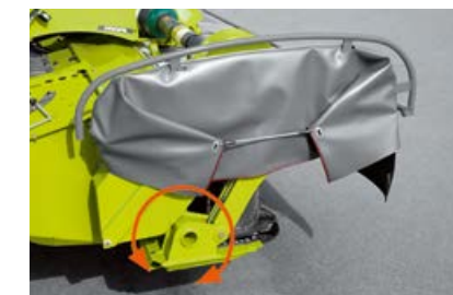
DISCO PROFIL seuraa pellon pintaa traktorin liikkeen sijasta matalalla sijaitsevan nivelkohdan ansiosta.
