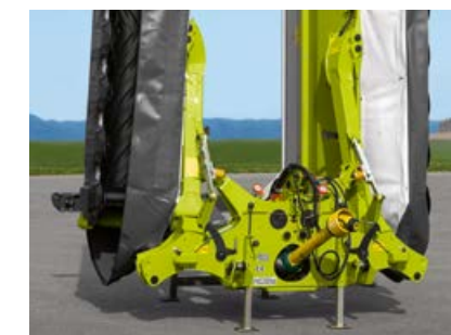
Tilaa säästävä: kaikkien suurtehoonittolaitteiden tukeva säilytysasento.
