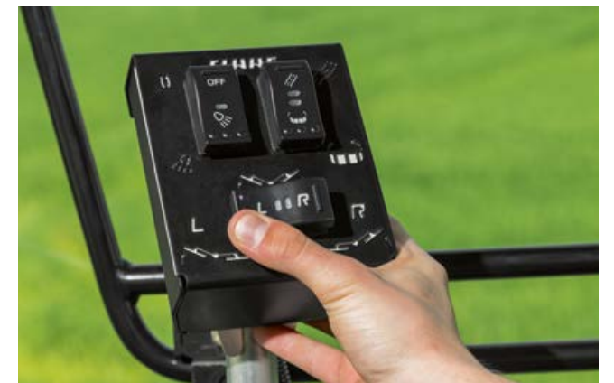
DISCO 1100 TREND -malliin on saatavissa käytännöllinen ohjausyksikkö erillisnostoa, koneen kuljetusasentoon taittoa sekä työvalojen päälle ja pois päältä kytkentää varten.
