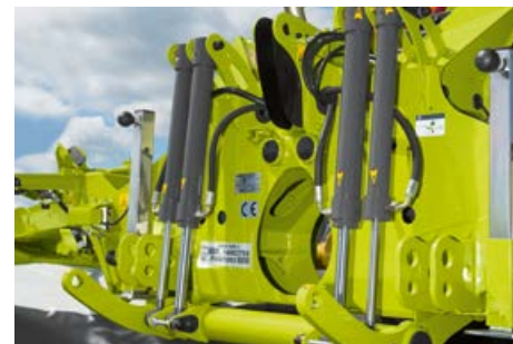
Vakiovarusteena oleva ACTIVE FLOAT nosto- ja keven- nyssylinteri takaa ruohonjuurien suojauksen.
