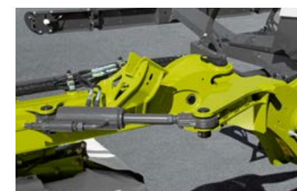
Non Stop hydraulinen laukaisulaite suojaaa törmäyksiltä: Niittolaitte kääntyy taakse ja sen jälkeen automaattisesti käyttöasentoon.
