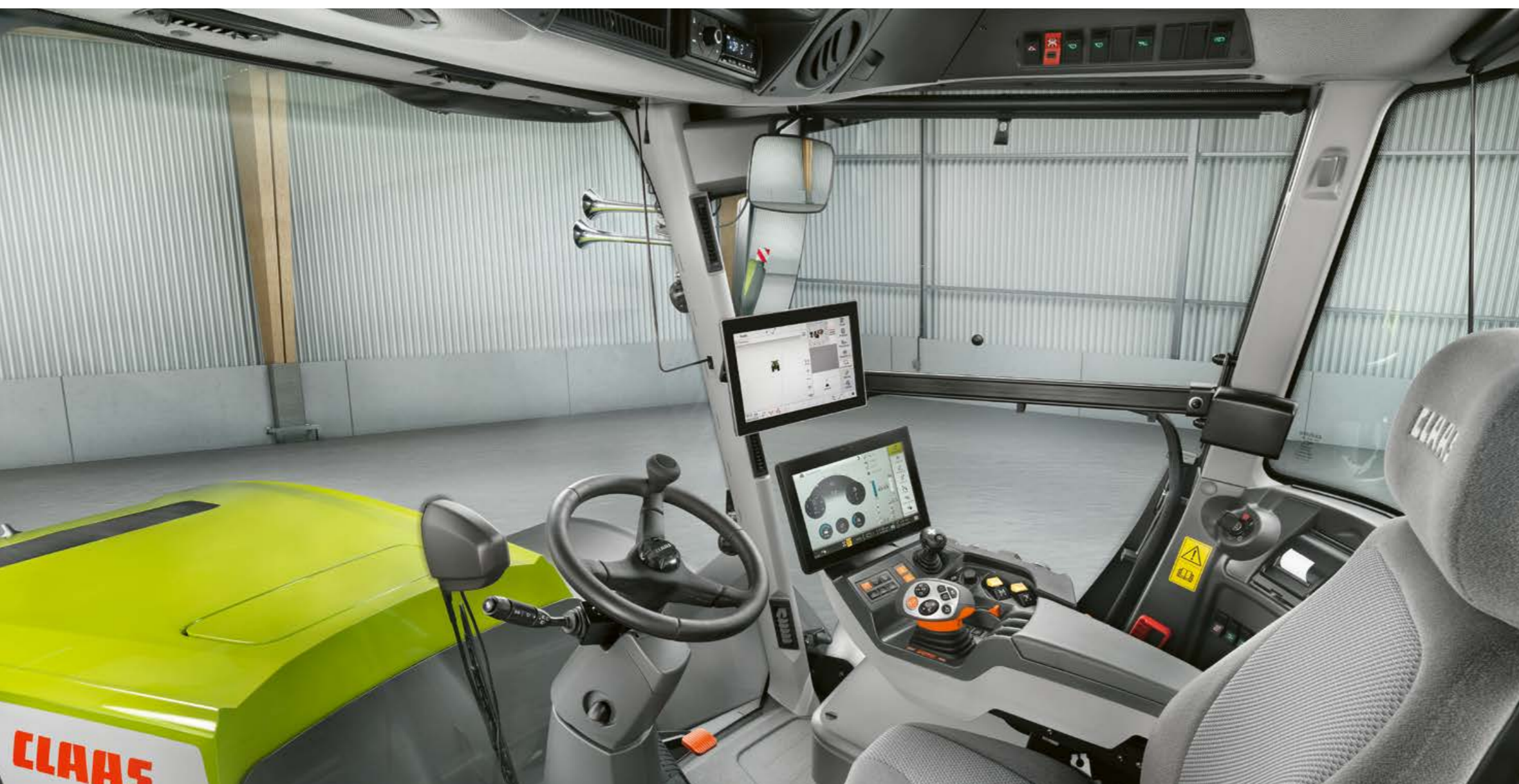
A TRAC VC rendelkezik a legkényelmesebb hátramenet berendezéssel ma a piacon. A vezetőfülkét kevesebb mint 30 mp alatt lehet 180°-kal elfordítani.
