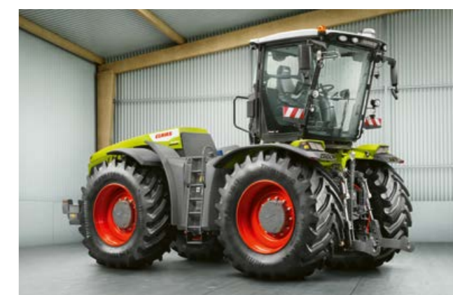
A TRAC VC rendelkezik a legkényelmesebb hátramenet berendezéssel ma a piacon. A vezetőfülkét kevesebb mint 30 mp alatt lehet 180°-kal elfordítani.
