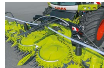
紧凑的存储空间，在收割时可以不受限制地看到ORBIS。运输保护装置安全存放在机器处。
