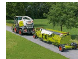
上方放置了DIRECT DISC直切割台的运粮车。
