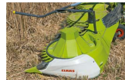
大尺寸倒伏玉米锥形装置优化作物流并防止收获物留在传送带上。
