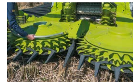
拆卸活塞式挡爪可增加作物流适用性。
