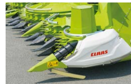
以液压形式驱动倒伏玉米尖端。
