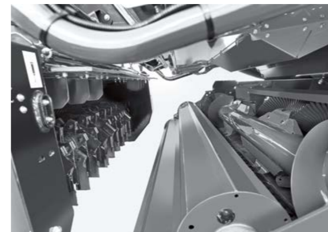
โรเตอร์คู่ทรงเกลียวพร้อมใบมีด 88 ใบเพื่อคุณภาพงานตัดสูง พืชใหญ่ได้สม่ำเสมอตลอดความกว้างการทำงาน 2 เมตร ชุดใบมีดสองแถวสามารถตั้งเป็นเชิกรับบาร์ได้หลายระดับด้วยใบมีด 45 ใบต่อแถว
