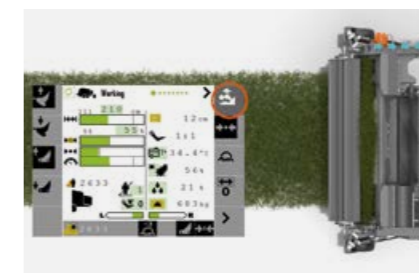
ระบบป้อนไฮดรอลิก PFS ปรับตั้งง่ายจากที่นั่งแทรกเตอร์
