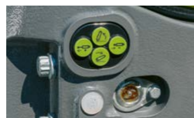
Comenzi externe pentru tiranții față și o supapă hidraulică cu echipament CEBIS.
