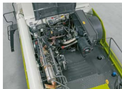
Cummins-motor z obdelavo izpušnih plinov AdBlue (Stage V).
