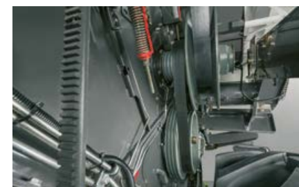
Pogon mlatilnega bobna z dvema enostavno nastavljivima območjema hitrosti vrtljajev.
