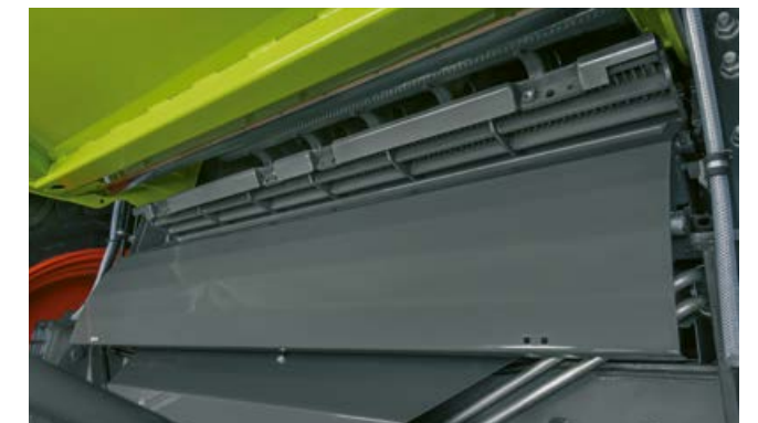
Segment košar je mogoče enostavno izvleči prek lovilnika kamnov.
