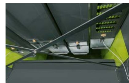
Odprtine za vzdrževanje na koncu pretresal omogočajo hiter dostop brez orodja.
