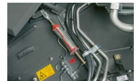
Vse mazalne točke so jasno označene in združene na centralnih mazalnih mestih.
