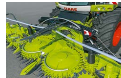
Depozitare compactă cu o vedere nerestricționată asupra hederului ORBIS în timpul recoltării. Protecția pentru transport este fixată în siguranță pe utilaj.
