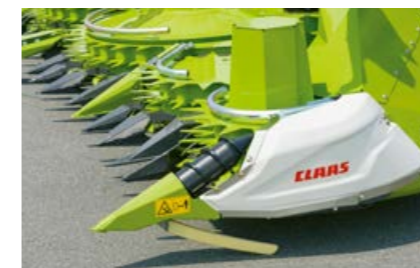
Vârful pentru porumb culcat poate fi acționat hidraulic.
