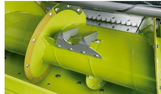
Diametrul melcului de alimentare de 600 mm pentru randament sporit.
