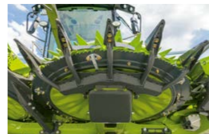
Degete de ghidare robuste și racletă sub discul cu lame pentru lucru curat.
