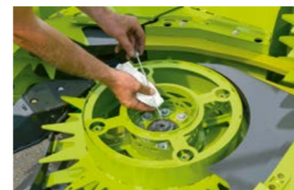
Joă pentru verificarea nivelului de ulei.
