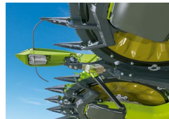
Senzor central AUTO CONTOUR disponibil pentru ORBIS 900.
