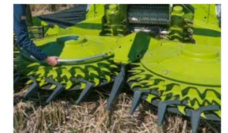
Demontarea elementelor de reținere a știuleților sporește fluxul de material recoltat.
