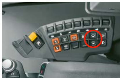
Un comutator pentru întregul proces de rabatare.
