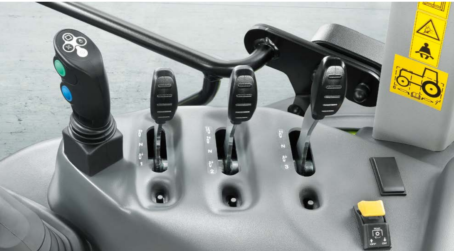
Det er muligt at begrænse den maksimale flowmængde for den mekaniske styreenhed nr. 3 via et greb i kabinen.
