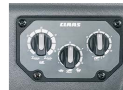
Regulace tažné síly, rychlost spouštění a omezení výšky zdvihu nastavíte pohodlně na pravé konzole.
