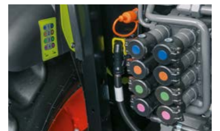
Připojky v zadní části jsou snadno rozeznatelné díky barevnému rozlišení a samolepkám umístěným v jejich blízkosti.
