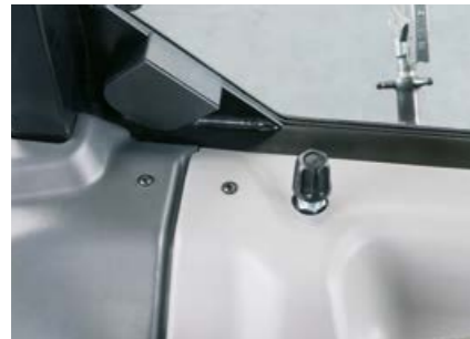
Maximální průtok mechanických rozvaděčů č. 3 lze omezit z kabiny obrátem ruky.
