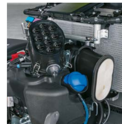
Vzduchový filtr PowerCore® je dobře přístupný vpředu pod kapotou motoru a zkracuje interval čištění.
