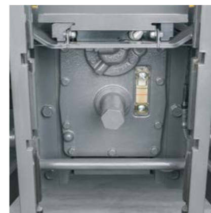
Stav oleje v převodovce a hydraulice můžete zkontrolovat přes průzor vedle zadního vývodového hřídele.
