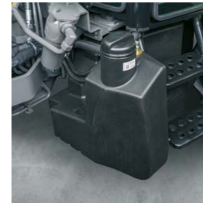
105 litran polttoainesäiliö ja 10 litran ureasäiliö varmistaa keskeytymättömän ajon pitkinäkin päivinä.
