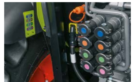
Takaosan liitokset tunnustetaan helposti värikoodauksen ja opastavien tarrojen avulla.
