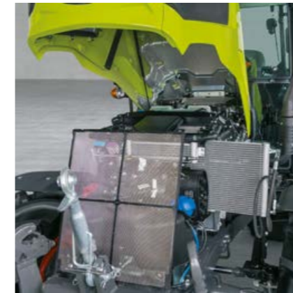
Jäähdytyn voidaan käden käänteessä kääntää ulos ja suojus voidaan irrottaa tarkistusta ja puhdistusta varten.
