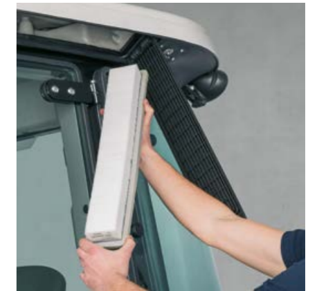
Ohjaamosuodattimeen pääsee ulkopuolelta helposti käsiksi ja se varmistaa jatkuvasti puhtaan ilman ohjaamossa.
