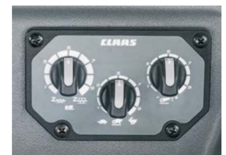
Vetovastussäätö, laskunopeus ja nostokorkeuden rajoitus säädetään helposti oikeanpuoleisesta sivupaneelista.
