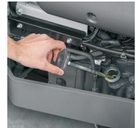
Moottoriöljyn määrän tarkistus ja lisäys voidaan tehdä konepeitto suljettuna traktorin oikealla puolella.
