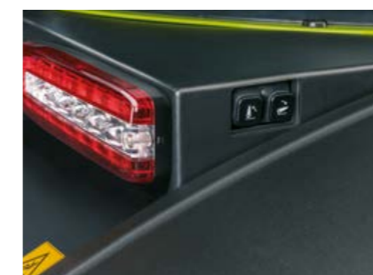
Takanostolaitetta voidaan ulkoisesti hallita molemmista takalokasuojista.
