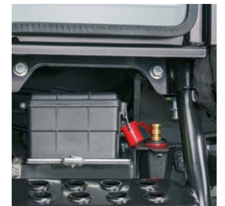
ELIOS 300 helpottaa jokapäiväistä työtäsi lukuisilla nerokkailla ratkaisuilla, kuten esim. ulkopuoliset akkuliittimet ohjaamon oikealla puolella.
