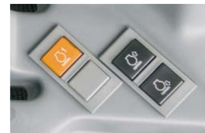
PTO-arbejde klares nemt med ELIOS – takket være memory for motoromdrejningstal som standard.
