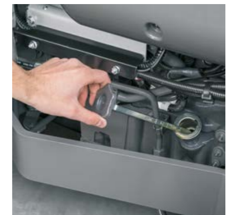
Oliestandskontrol og påfyldning sker i højre side af ELIOS 200 med motorhjelmen lukket.
