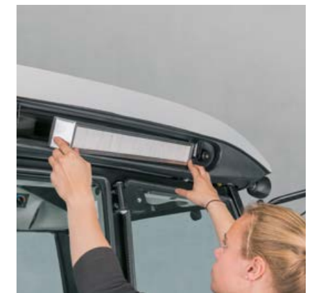
Kabinefiltret er lettilgængeligt udefra i forbindelse med rengøring, og det giver dig altid frisk luft i kabinen.
