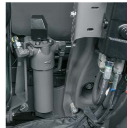
Motorens filter er let at komme til selv med frontlæsserkonsoller.
