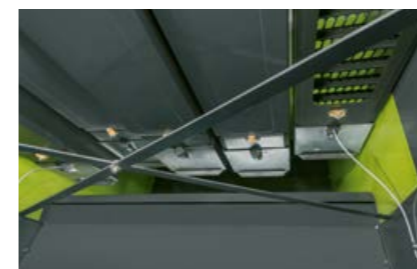
Techninei priežiūrai skirtos angos šiaudų kratiklių gale užtikrina greitą prieigą nenaudojant įrankių.
