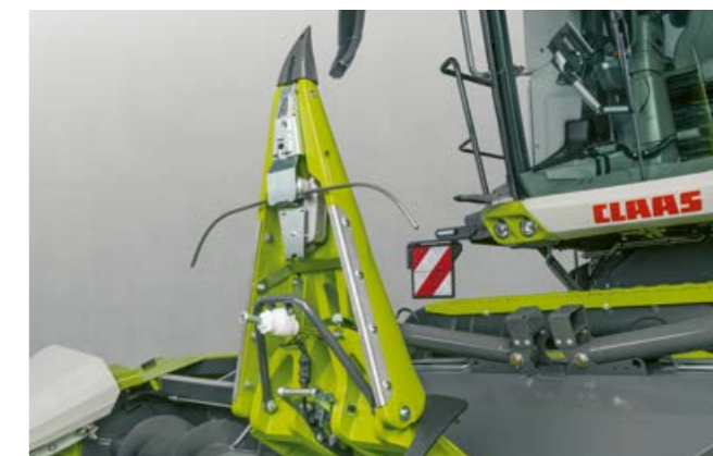
Dvi jutiklių juostos skenuoja po vieną kukurūzų eilę.
