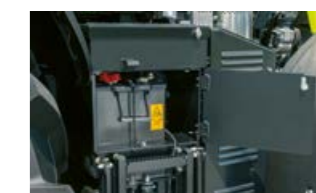
Na pravé straně u nástupních schodků je uložena baterie.
