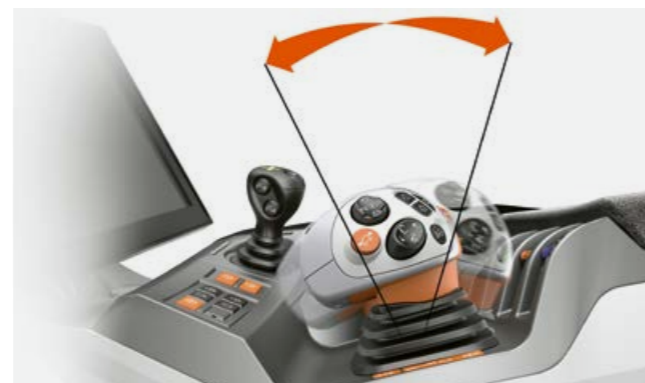
Progressivní ovládání s technologií plynulé převodovky CMATIC.
