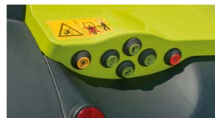
Externí obslužné prvky pro zadní zvedací závěs, vývodový hřídel a jeden volitelný rozvaděč (pouze CEBIS).
