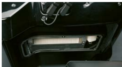
God adgang til friskluftfilteret til kabinen.
