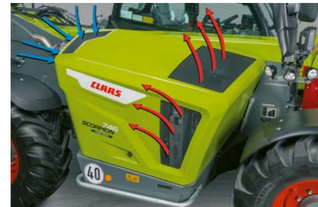
Føreren kan altid aktivere en manuel reversering.
