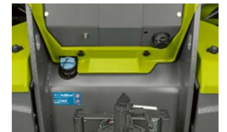
Let tilgængelig AdBlue®-påfyldningsstuds for en effektiv udstødningsefterbehandling.
