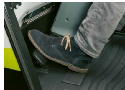
Bremsepedalen med inchfunktion reducerer brændstofforbruget og bremsesliddet.
