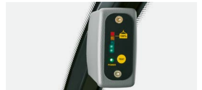
Belastningsindikator med entydig lyssignalssymbolik: Når stabilitetsgrænsen er nået, lyser alle dioder, og der høres en alarmtone.
