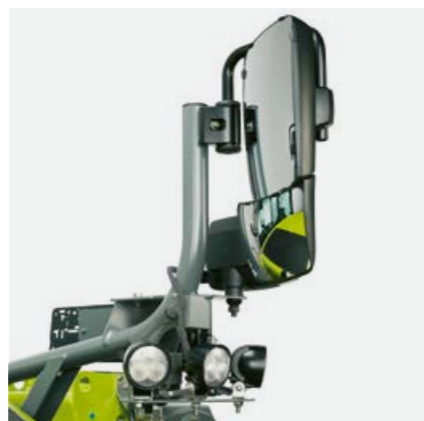
Ratstamme med indstilling i tre retninger (højde, vinkel og hældning).
