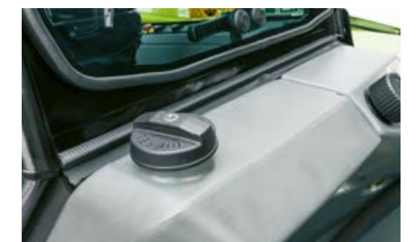
Låsbar brændstoftank bag kabinen.
