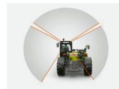
Frit udsyn bagud takket være den lavtplacerede teleskoparm – det giver større arbejdssikkerhed.
