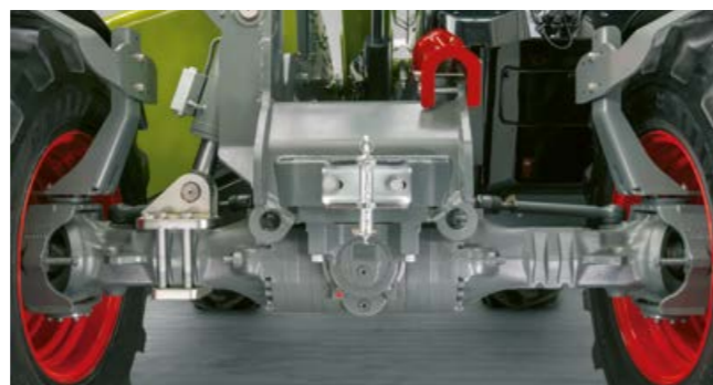
Undervogn med hydraulisk niveaudigning.
