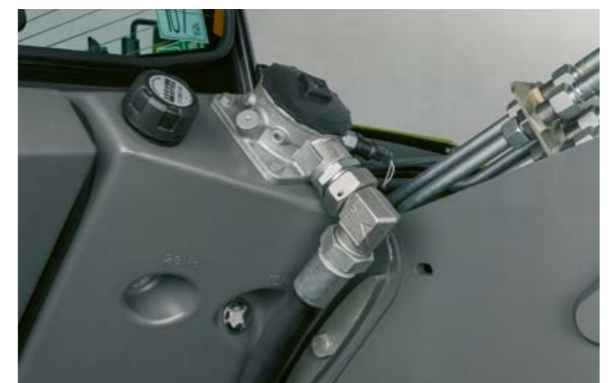
Hydraulikoliestanden kan aflæses nemt via en inspektionsrude. Hydrauliksystemet er beskyttet af et returlobsfilter. Udskift først filteret efter 1.000 timers drift.
