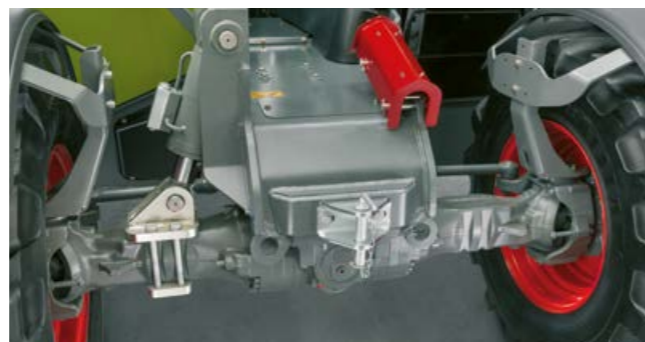
Større sikkerhed i terrænet med hydraulisk niveaudigning.
