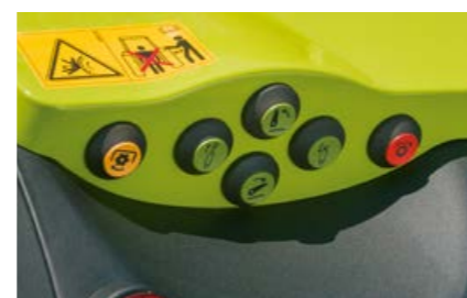
Aizmugurējās jūgvārpstas ārējās vadības ierīces uz abiem dubļusargiem.
