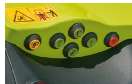
Takavoimanottoa voidaan käyttää molemmissa lokasuojissa olevilla napeilla.
