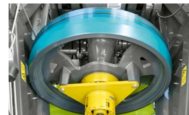
Den nye svinghjulsversion: Større masse og træghed for bedre effekt.
