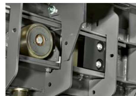
De drejelige knive kan monteres i to stillinger til brug i halm / majshalm eller i hø / ensilage.
