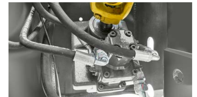
Két olajszivattyú szállítja a hidraulikaolajat a hajtóműhöz és a TURBO FAN kötérgégység-tisztítórendszerhez.
