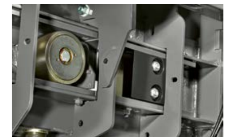
A forgatható dugattyúkészek két pozícióban rögzíthetők szalmához/kukoricaszárhoz vagy szénához/szilázsához való használatra.
