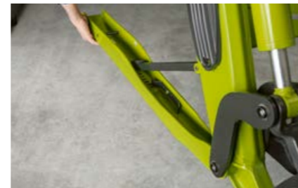
Seisontatuet nostetaan aisastoa vasten eivätkä ne häiritse näkyvyyttä työvarusteelle.
