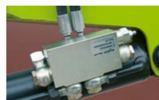
Mallisarjojen FL ja FL C sähköisen vaihdon ansiosta voidaan varoventtiili yhdistää SHOCK ELIMINATOR heiluntavaimennuksen kanssa.
