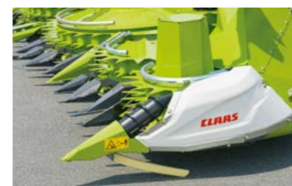
Hidrauliski darbināms pagarinātājs sagulušai kukurūzai
