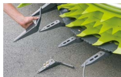
Noņemamie šķirēji vēl labāk paceļ sagulušu kukurūzu
