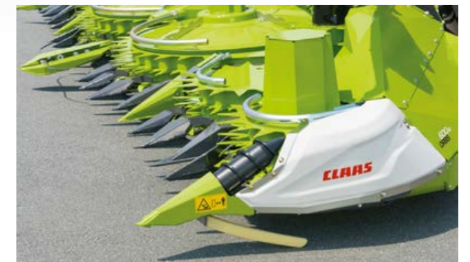
Ja kukurūza ir veldrē, var izmantot hidrauliski darbināmos šnekus
