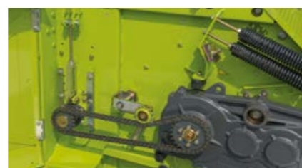
DIRECT DISC 600 P / 500 P: lāpsta veida veltna augstuma regulēšana; pieejama arī hidrauliska tās regulēšana (izvēles opcija)
