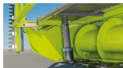
Regulējami vāla piespiedēji; izvēles opcija ir hidrauliski darbināmas
