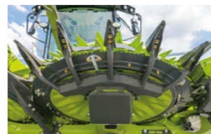
Izturīgi šķirēji un izvade zem nažu diskām, lai darbs notiktu bez aizķeršanās
