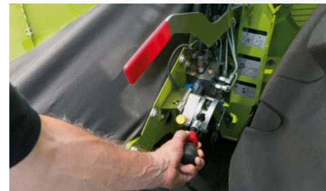
Padeves ruļļu trīspakāpju ātruma pielāgošana optimālai augu materiāla plūsmai
