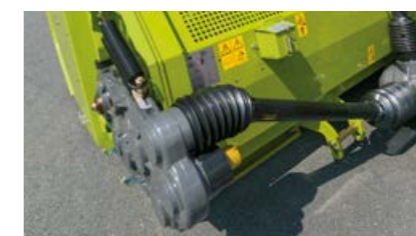
Jaudīgs piedziņas mehānisms ar trīspakāpju pārnesumkārbu
