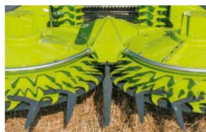
Šaurs centrēšanas šķirējs lapu kultūru (pilnaugu) novākšanas laikā aiz sevis atstāj labākas formas rugājus
