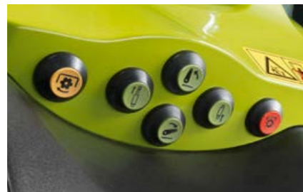
Ārējās vadības ierīces aizmugures uzkairei, jūgvārpstai un vienam hidraulikas izvadam pēc jūsu izvēles.
