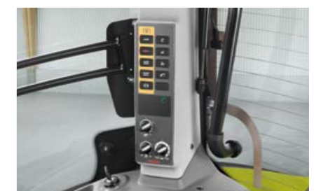
Jūgvārpstas griešanās ātrumus un elektronisko aizmugurējās uzkares vadības sistēmu var regulēt uz B statņa.
