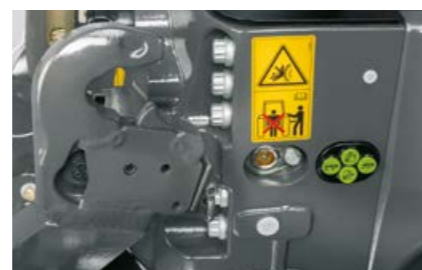
Ārējās vadības ierīces priekšējai uzkarei un vienam hidraulikas izvadam.
