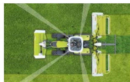
Pateicoties īpašam kabīnes aizmugurējo statņu izkārtojumam un izliektajam aizmugurējā loga stiklam, operatoram ir nodrošināta optimāla agregāta un sakabes zonas pārredzamība.
