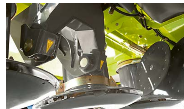
A talajközeli forgópont a kasza biztos hosszirányú vezetését eredményezi
