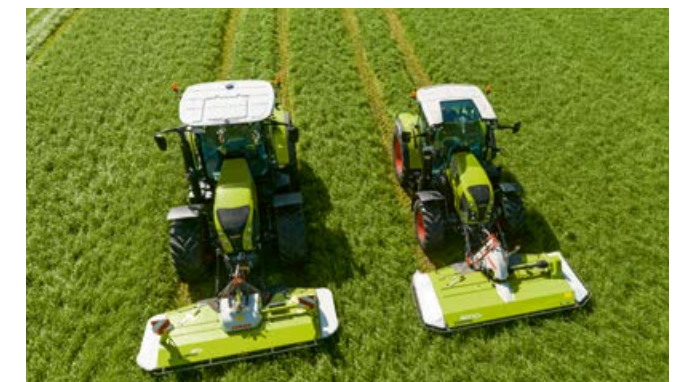
Rendszélesség egy vagy két pár rendképzőtárcsával
