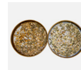
Sítová zkouška zobrazuje vpravo SHREDLAGE® s vysokým stupněm pomačkání zrna v porovnání s běžnou siláží vlevo
