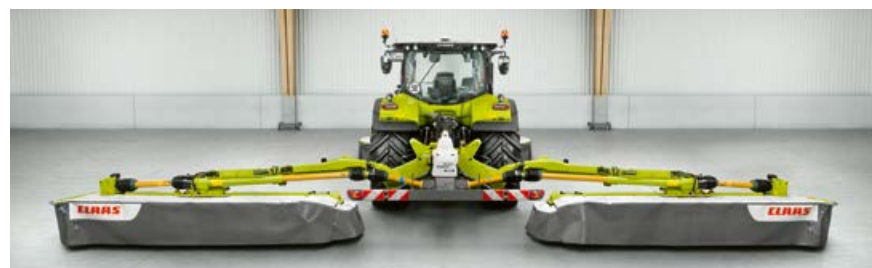
Divas hidrauliski vadāmas teleskopiskas izlīces ar pastāvīgu pielāgošanos. Strādājot ar DISCO 1100 TREND, tas nodrošina optimāli pārklājošu pļaušanu.
