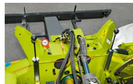
Manometrs ērtai abu pļaujmašīnas segmentu piespiedējspēka iestatišanai.
