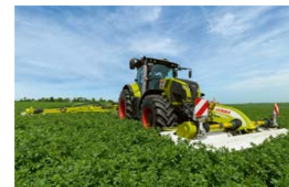
Frontālai pļaujmašīnai ir papildu opcijas, piemēram, ātruma kontrole, ACTIVE FLOAT vadība un aizsargpārklāja salocīšana.
