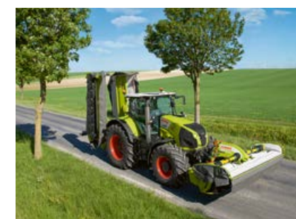
Kompakta transporta pozīcija drošībai braucot pa koplietošanas ceļiem.
