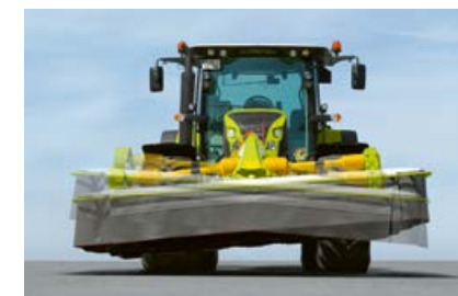
Brīvi svārstīga pamatne, lai braukšanas virzienā pilnībā pielāgotos reljefam visā darba platumā.
