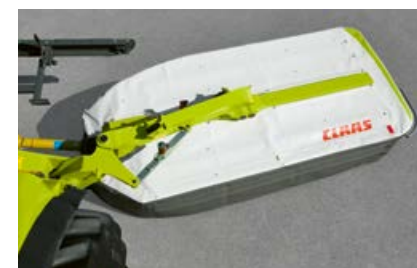
Mehāniska aizsardzības sistēma: sadursmes gadījumā mašīna padodas atpakaļ un nedaudz uz augšu (DISCO 1100 TREND modelim ir hidrauliska "non-stop" aizsardzība sistēma).
