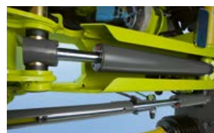
Divi atsevišķi cilindri celšanai un ACTIVE FLOAT amortizācijai ļauj brauciena laikā pielāgoties spiedienam uz augsni.
