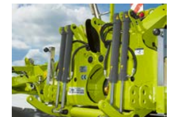
Sērjveidā uzstādītie ACTIVE FLOAT pacelšanas un atslogošanas cilindri garantē, ka tiks saudzēta velēna.
