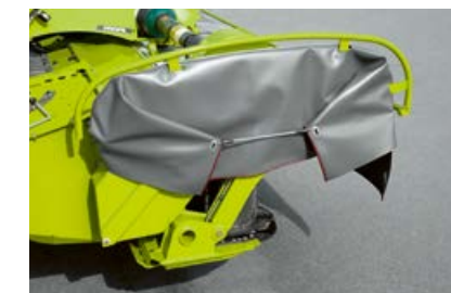
Pateicoties zemajam pagriešanās punktam, DISCO PROFIL seko virsmas reljefam, nevis traktoram.
