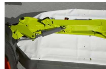
Aizsardzība sadursmes gadījumā ar hidraulisko "non-stop" aizsardzības sistēmu – pļaujmašīna pagriežas un automātiski atgriežas sākuma pozīcijā.
