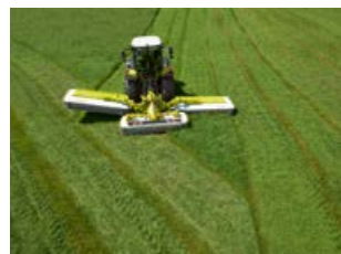
Individuāla pļaujmašīnu pacelšanas funkcija, lai apgrieztos lauka malā.
