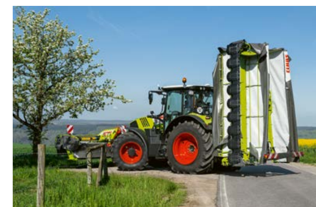
Mazāk nekā 4 m augsts un kompakts no visām pusēm – kā jau visi DISCO modeļi. Abas pļaujmašīnas teleskopiski savelkas, un mašīnu pēc tam saloka transporta pozīcijā.
