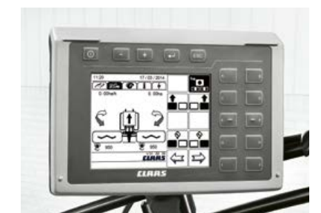
OPERATOR: ergonomisks vadības terminālis ar lielu ekrānu un izgaismotiem taustiņiem vadības funkciju priekšizvēlei.
