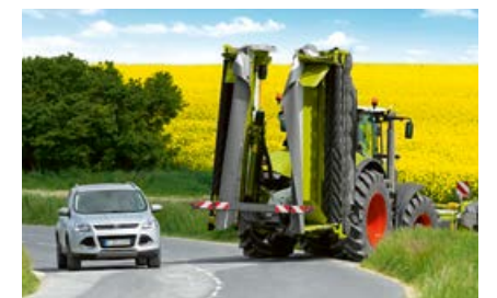
Mazāk par četriem metriem: abiem BUSINESS modeļiem ir kompakta transporta pozīcija ar lielu klīrensu.
