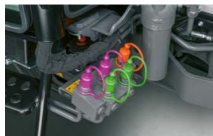
Inntil fire hydraulikkuttak og fri retur er tilgjengelig foran.
