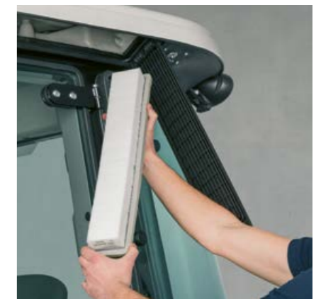
Førerhusfilteret er lett tilgjengelig for rengjøring fra utsiden og sørger for et friskt klima i førerhuset.
