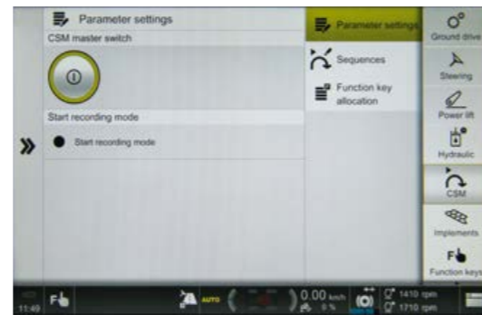
Nustatykite parametrus CSM apžvalgos ekrane. Pagal poreikį galite priskirti funkcinus mygtukus, esančius ant valdymo svirties.
