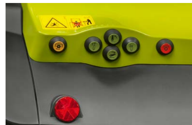
Vnější ovládání zadního vývodového hřídele.
