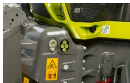
Externí ovládání čelního zvedacího závěsu a hydraulický rozvaděč (v závislosti na vybavení).
