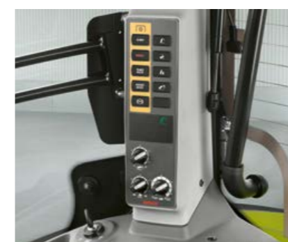
Počet otáček vývodového hřídele a elektronická regulace zvedacího závěsu jsou nastavitelné na B-sloupku.
