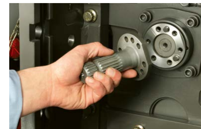
Snadná výměna koncovky vývodového hřídele.
