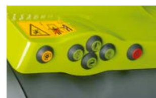
Externí obslužné prvky pro zadní zvedací závěs, vývodový hřídel a jeden voltelný rozvaděč (pouze CEBIS).
