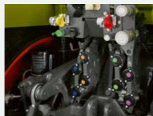
Vzduchová brzdová soustava s vysoušečem vzduchu.
