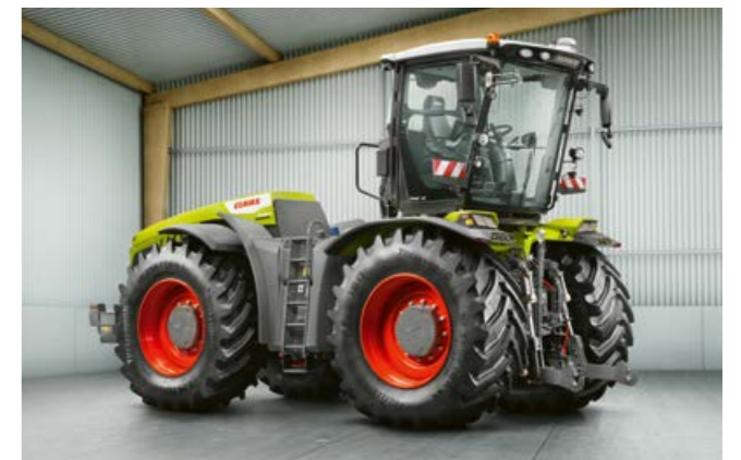
TRAC VC ir ērtākā reversas piedziņas sistēma tirgū. To ir iespējams pagriezt par 180° mazāk nekā 30 sekundēs.
